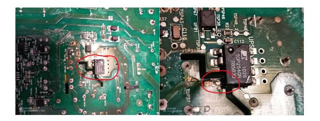
Fusibles imprimés sur circuit
