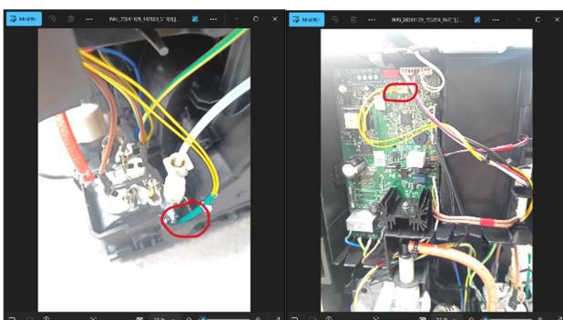
Remplacement de la sonde remontage et essai.
