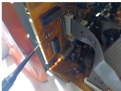
Tout porte à envisager que ce soit la partie laser qui dysfonctionne, donc : la cellule laser (PEA1030) ou le, ou les trois circuits intégrés qui gères la cellule, les moteurs du lecteur CD : (CXD2500Q et CXA1372Q), le driver de la cellule (CXA1471S), je pencherais pour lui.
