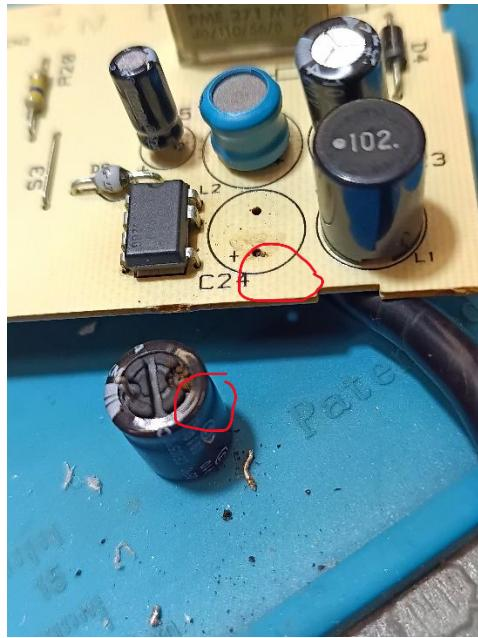
Pate du C24 2.2 $\mu$ F 400V (équivalent du C3 sur le schéma) complètement oxydée remplacer par un 6.8 $\mu$ F 450V
