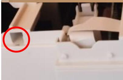
Cela permet d'enlever le 'capot' scanner en soulevant à droite et en poussant vers la gauche.
