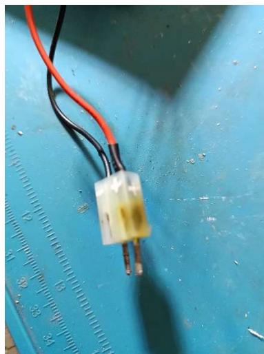
Test de l'alim à pleine charge (ok fonctionne bien 12Vcc 5.5A
