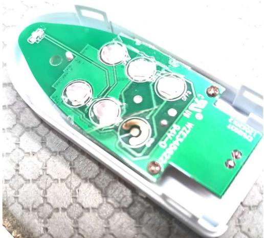
Démontage de la télécommande inspection visuel révèle qu'il y a de l'oxydation sous la capsule ON de la touche en question.
